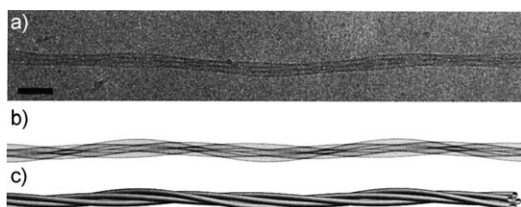
Abbildung 16. a) Cryo-TEM-Aufnahme einer einzelnen viergliedrigen Helix. Der Maßstabsbalken entspricht 50 nm. b) Simulierte Projektion dieser Helix und c) die entsprechende dreidimensionale Darstellung. Wiedergabe aus Lit. [73] mit Genehmigung. Copyright (2000) American Chemical Society.
